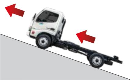
• Con el control computarizado se mantiene la fuerza de frenado aunque el conductor suelte el freno, y con la maniobra de arranque, se desbloquea el freno automáticamente, lo que permite un arranque seguro, suave en las cuestas y una reducción de la fatiga del conductor.
